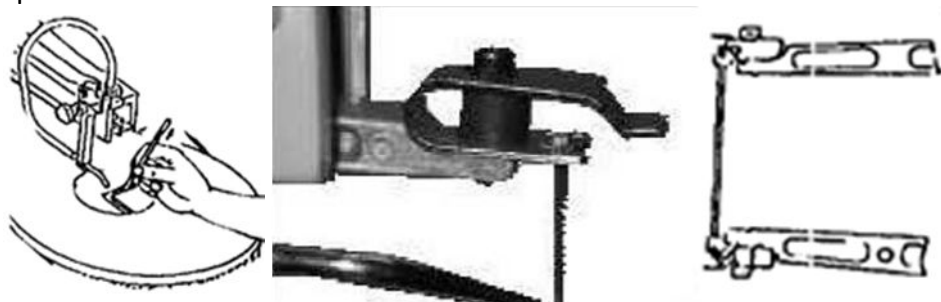
Мал. 3 Схема установки пильного полотна
