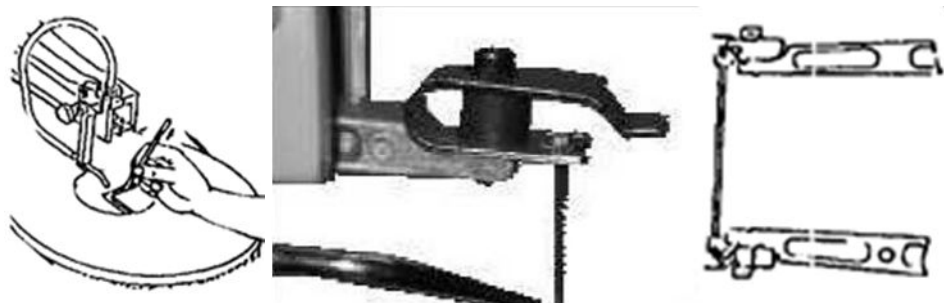
Рис. 3 Схема установки пильного полотна
