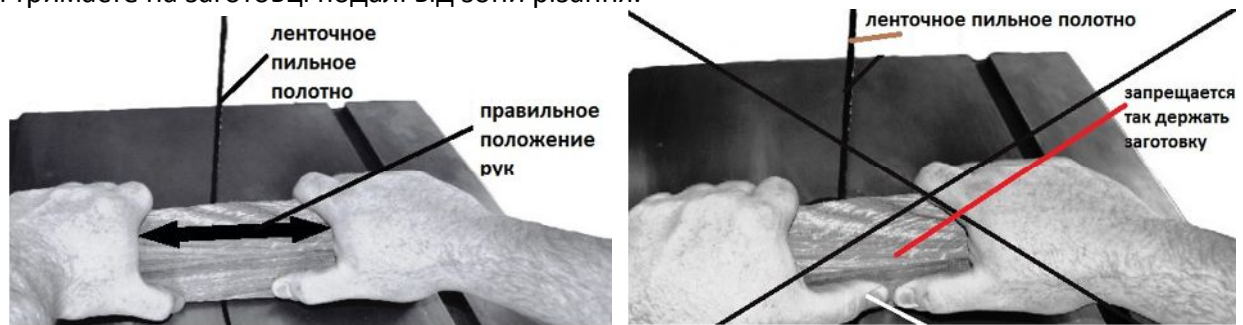
Рис. 1 Схема розпилювання заготовки
