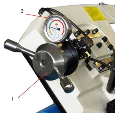
Рис. 6 Натяжение пильного полотна
